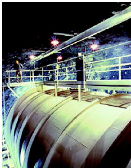
Рис. 16.12а. Бак, наполненный четыреххлористым углеродом и сопутствующие конструкции в эксперименте Дэвиса
